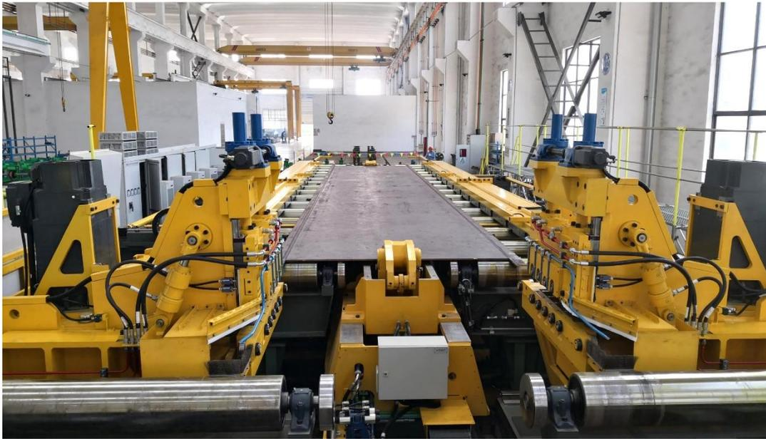
图 1.1 油气输送直缝埋弧焊管智能生产线之铣边机产品图
