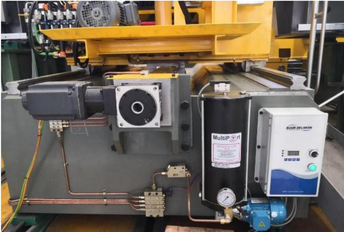
图 1.3 油气输送直缝埋弧焊管智能生产线之铣边机产品图
